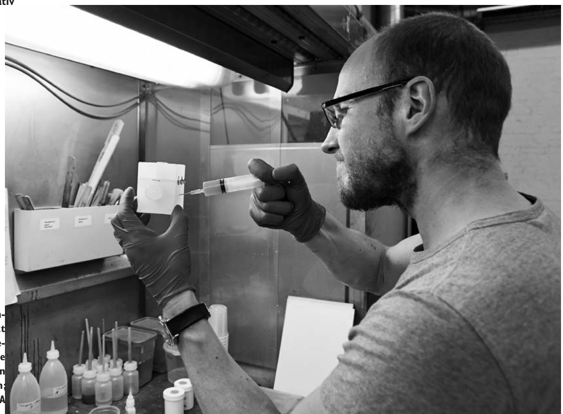
Einbauen der ausgedruckten Positivform in eine Gussform für das Silikon-Negativ
